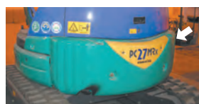
Contrapesos para maquinaria de construcción
