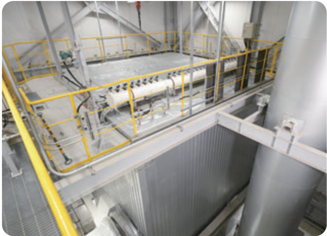
7 过滤式除尘器 废气中所含的粉尘和有害物质会被过滤器收集去除。
